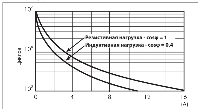
F 46 - Электрическая долговечность (АС) при ном. нагрузке Тип 46.61
