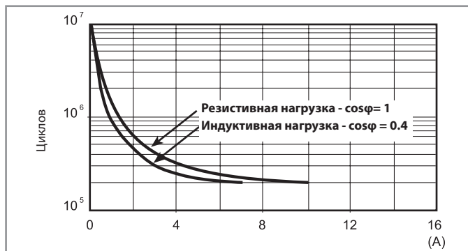
F 60 -Электрическая долговечность (AC) при ном. нагрузке
