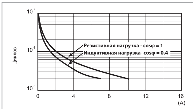
H 55 - Макс. отключающая способность DC1
