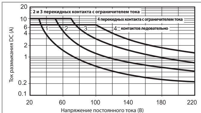
H 55 - Макс. отключающая способность DC1
