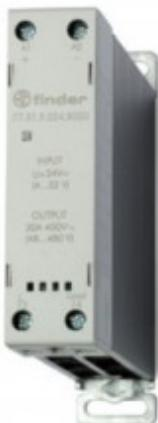
**773182308051PAS, Модульное твердотельное реле; выход 30A (60...440В AC); питание 230В AC; Функция 'Произвольн.включ.'; ширина 22.5мм; клем.реле; степень защиты IP20; упаковка 1шт.**
