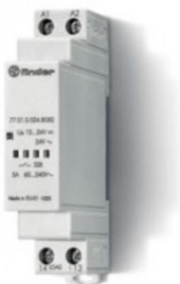
**770190249125PAS, Модульное твердотельное реле; выход 7A (125В DC); питание 6...24В DC; ширина 17.5мм; степень защиты IP20; упаковка 1шт.**
