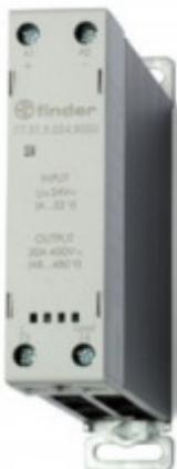
**773190248051PAS, Модульное твердотельное реле; выход 30A (60...440В AC); питание 24В DC; Функция 'Произвольн.включ.'; ширина 22.5мм; клем.реле; степень защиты IP20; упаковка 1шт.**
