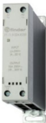
**771182308250PAS, Модульное твердотельное реле; выход 15A (24...280В AC); питание 230В AC; Функция 'Включ.при пересечении нуля'; ширина 22.5мм; клем.реле; степень защиты IP20; упаковка 1шт.**
