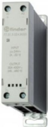
**773190248050PAS, Модульное твердотельное реле; выход 30A (60...440В AC); питание 24В DC; Функция 'Включ.при пересечении нуля'; ширина 22.5мм; клем.реле; степень защиты IP20; упаковка 1шт.**
