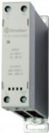
**773182308050PAS, Модульное твердотельное реле; выход 30A (60...440В AC); питание 230В AC; Функция 'Включ.при пересечении нуля'; ширина 22.5мм; клем.реле; степень защиты IP20; упаковка 1шт.**
