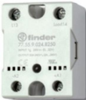
**775590248650PAS, Твердотельное реле; выход 50A (48...600В АС); питание 24В DC; Функция 'Включ.при пересечении нуля'; монтаж на панель; степень защиты IP20; упаковка 1шт.**
