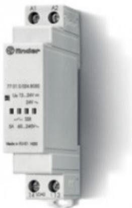
**770190249024PAS, Модульное твердотельное реле; выход 15A (24В DC); питание 6...24В DC; ширина 17.5мм; степень защиты IP20; упаковка 1шт.**
