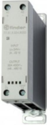
**773182308070PAS, Модульное твердотельное реле; выход 30A (60...440В AC); питание 230В AC; Функция 'Включ.при пересечении нуля'; ширина 22.5мм; клем.контактор; степень защиты IP20; упаковка 1шт.**
