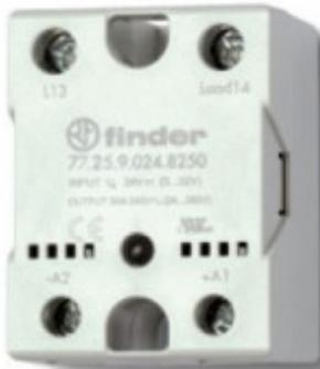
**772590248250PAS, Твердотельное реле; выход 25A (24...240В AC); питание 24В DC; Функция 'Включ.при пересечении нуля'; монтаж на панель; степень защиты IP20; упаковка 1шт.**
