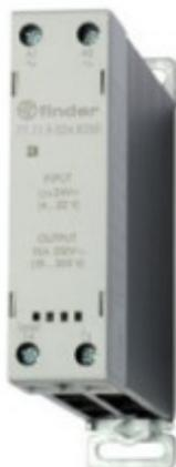
**771190248251PAS, Модульное твердотельное реле; выход 15A (24...280В AC); питание 24В DC; Функция 'Произвольн.включ.'; ширина 22.5мм; клем.реле; степень защиты IP20; упаковка 1шт.**
