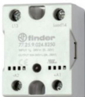
**772582308250PAS, Твердотельное реле; выход 25A (24...240В AC); питание 230В AC; Функция 'Включ.при пересечении нуля'; монтаж на панель; степень защиты IP20; упаковка 1шт.**
