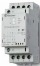
**223400121320PAS, Модульный контактор; 4NO 25A; контакты AgNi; катушка 12В AC/DC; ширина 35мм; степень защиты IP20; опции: мех.индикатор + LED; упаковка 1шт.**
