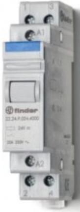
**222490244000PAS, Модульный контактор; 2NC 20A; контакты AgSnO<sub>2</sub>; катушка 24В DC; ширина 17.5мм; степень защиты IP20; опции: нет; упаковка 1шт.**
