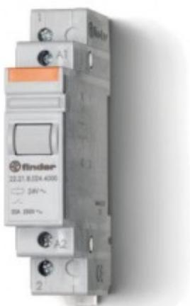
**222182404000PAS, Модульный контактор; 1NO 20A; контакты AgSnO2; катушка 240В AC; ширина 17.5мм; степень защиты IP20; опции: нет; упаковка 1шт.**
