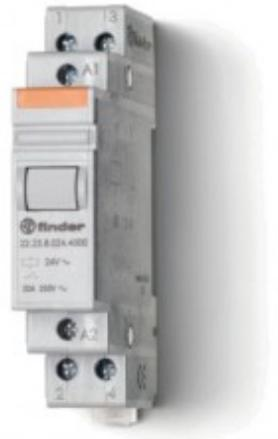
**222380084000PAS, Модульный контактор; 1NO+1NC 20A; контакты AgSnO<sub>2</sub>; катушка 8В AC; ширина 17.5мм; степень защиты IP20; опции: нет; упаковка 1шт.**
