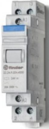
**222490484000PAS, Модульный контактор; 2NC 20A; контакты AgSnO<sub>2</sub>; катушка 48В DC; ширина 17.5мм; степень защиты IP20; опции: нет; упаковка 1шт.**
