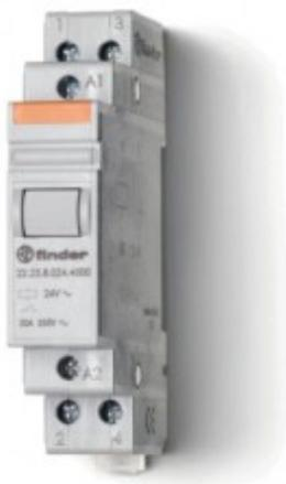
**222382304000PAS, Модульный контактор; 1NO+1NC 20A; контакты AgSnO<sub>2</sub>; катушка 230В AC; ширина 17.5мм; степень защиты IP20; опции: нет; упаковка 1шт.**
