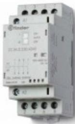
**223402304640PAS, Модульный контактор; 2NO+2NC 25A; контакты AgSnO<sub>2</sub>; катушка 230В AC/DC; ширина 35мм; степень защиты IP20; опции: переключатель Авто-Вкл-Выкл + мех.индикатор + LED; упаковка 1шт.**
