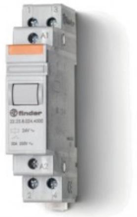
**222380124000PAS, Модульный контактор; 1NO+1NC 20A; контакты AgSnO<sub>2</sub>; катушка 12В AC; ширина 17.5мм; степень защиты IP20; опции: нет; упаковка 1шт.**
