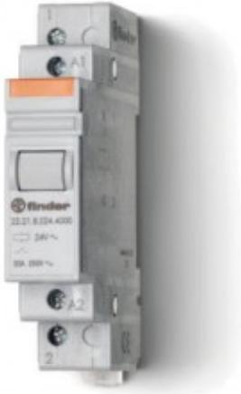
**222180244000PAS, Модульный контактор; 1NO 20А; контакты AgSnO<sub>2</sub>; катушка 24В АС; ширина 17.5мм; степень защиты IP20; опции: нет; упаковка 1шт.**
