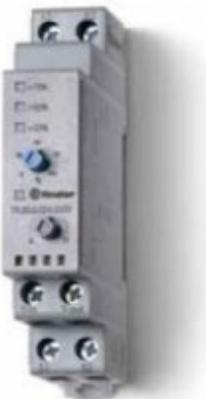
**195000240000PAS, Модуль управления, аналоговый сигнал 0...10В DC; питание 24В AC/DC; монтаж на рейку 35мм; ширина 17.5мм; степень защиты IP20; упаковка 1шт.**
