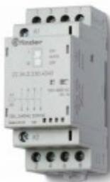
**223400244340PAS, Модульный контактор; 4NO 25A; контакты AgSnO2; катушка 24В AC/DC; ширина 35мм; степень защиты IP20; опции: переключатель Авто-Вкл-Выкл + мех.индикатор + LED; упаковка 1шт.**
