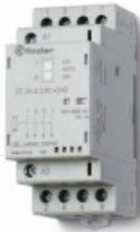
**223400124320PAS, Модульный контактор; 4NO 25A; контакты AgSnO2; катушка 12В AC/DC; ширина 35мм; степень защиты IP20; опции: мех.индикатор + LED; упаковка 1шт.**
