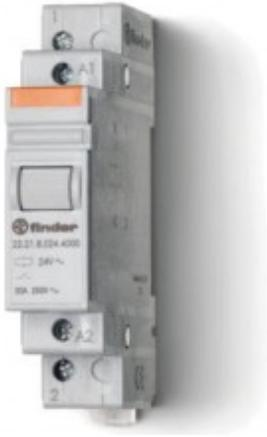
**222180124000PAS, Модульный контактор; 1NO 20А; контакты AgSnO<sub>2</sub>; катушка 12В АС; ширина 17.5мм; степень защиты IP20; опции: нет; упаковка 1шт.**
