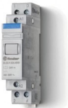
**222282404000PAS, Модульный контактор; 2NO 20A; контакты AgSnO2; катушка 240В AC; ширина 17.5мм; степень защиты IP20; опции: нет; упаковка 1шт.**
