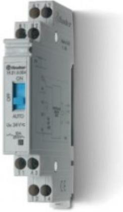
**192100240000PAS, Модуль управления Авто-Вкл-Выкл; 1CO 10А; питание 24В AC/DC; монтаж на рейку 35мм; ширина 11.2мм; степень защиты IP20; упаковка 1шт.**
