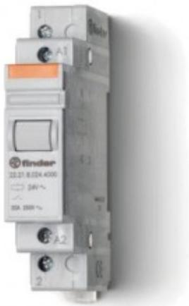
**222181204000PAS, Модульный контактор; 1NO 20A; контакты AgSnO2; катушка 120В AC; ширина 17.5мм; степень защиты IP20; опции: нет; упаковка 1шт.**
