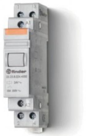
**222380244000PAS, Модульный контактор; 1NO+1NC 20A; контакты AgSnO<sub>2</sub>; катушка 24В AC; ширина 17.5мм; степень защиты IP20; опции: нет; упаковка 1шт.**
