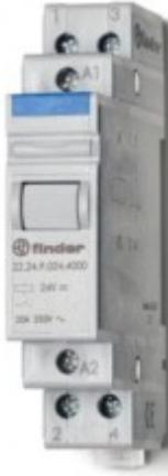
**222481104000PAS, Модульный контактор; 2NC 20A; контакты AgSnO2; катушка 110В AC; ширина 17.5мм; степень защиты IP20; опции: нет; упаковка 1шт.**
