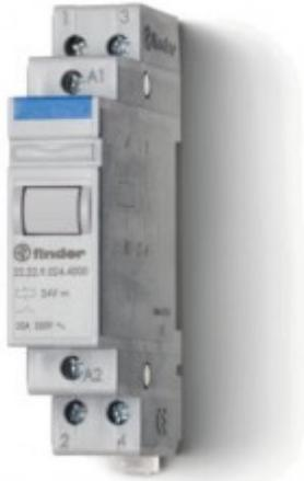
**222280244000PAS, Модульный контактор; 2NO 20A; контакты AgSnO2; катушка 24В AC; ширина 17.5мм; степень защиты IP20; опции: нет; упаковка 1шт.**
