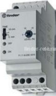
**71.11.8.230.1010 | 711182301010 | Реле контроля напряжения;  $\pm 5 - \pm 20\% U_n$ ; задержка 5-10 мин.; 1 перекидной контакт 10A (~ 230В AC)**
