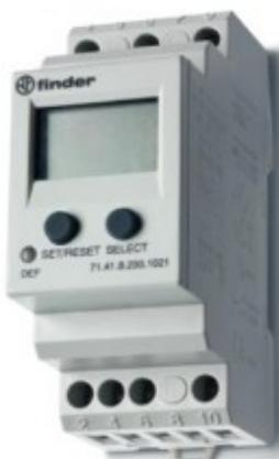
**714182301021PAS, Универсальное контрольное реле напряжения для 1-фазных сетей AC/DC; пониженное/повышенное напряжение; настраиваемые параметры; память отказов; выход 1CO 10A; модульное, ширина 35мм; степень защиты IP20; упаковка 1шт.**
