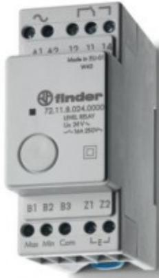
**721190240000PAS, Реле контроля уровня; фиксированный диапазон чувствительности 150кОм; питание 24В DC; выход 1CO 16А; модульное, ширина 35мм; степень защиты IP20; упаковка 1шт.**
