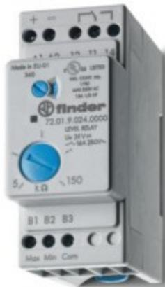
**720182400000PQA, Реле контроля уровня, настраиваемый диапазон чувствительности 5...150 кОм, питание 240 В АС, выход 1СО 16А, модульное, ширина 35 мм, степень защиты IP20, в комплекте 2 x 072.31, упаковка 5шт.**
