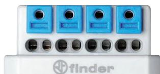
Двойные клеммы обеспечивают удобный монтаж перемычек между несколькими приборами. Макс.сечение провода для каждой клеммы составляет 2.5 мм<sup>2</sup>.
