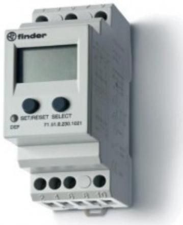
**715182301021PAS, Универсальное контрольное реле тока для 1-фазных сетей AC/DC; пониженный/повышенный ток; прямое подключение или через трансформатор тока; настраиваемые параметры; память отказов; выход 1CO 10А; модульное, ширина 35мм; степень защиты IP20; упаковка 1шт.**
