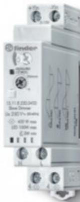
**151182300400PAS, Модульный ведомый электронный диммер (Slave); управление сигналом 0-10В от ведущего диммера (Master); разные типы ламп, до 400Вт; питание 230В АС (50Гц); степень защиты IP20; упаковка 1 шт.**
