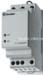
**71.11.8.230.0010 | 711182300010 | Реле контроля напряжения; 1,2 - 0,75 Un; задержка 5-10 мин.; 1 перекидной контакт 10A (~ 230В AC)**
