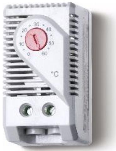
Контроль нагрева, при падении температуры в шкафу ниже уставки (MIN), контакт сработает. Когда температура будет равна уставки (MIN) контакт вернётся в исходное положение.
