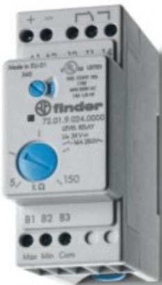
**720180240000POA, Реле контроля уровня, настраиваемый диапазон чувствительности 5...150 кОм, питание 24 В AC, выход 1CO 16А, модульное, ширина 35 мм, степень защиты IP20, в комплекте 2 x 072.02.06, упаковка 5шт.**
