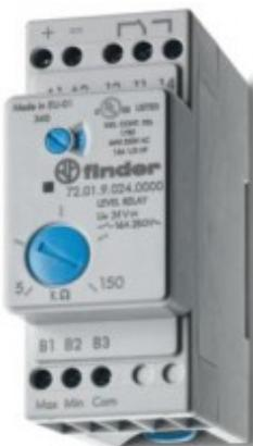
**720180240000PQA, Реле контроля уровня, настраиваемый диапазон чувствительности 5...150 кОм, питание 24 В AC, выход 1CO 16А, модульное, ширина 35 мм, степень защиты IP20, в комплекте 2 x 072.31, упаковка 5шт.**
