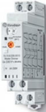
**151082300010PAS, Модульный ведущий электронный диммер (Master); 4 функции; сигнал 0-10В; подключение до 32 ведомых диммеров (Slave); управление до 15 кнопок с подсветкой; питание 230В АС (50Гц); степень защиты IP20; упаковка 1 шт.**
