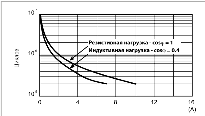
H 58 - Макс. отключающая способность DC1
