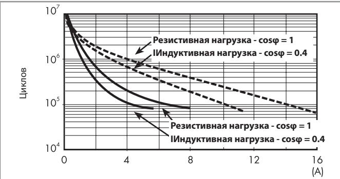
F 38 - Электрическая долговечность (AC) при ном. нагрузке, 1 полюс 16 А и 2 полюса 8 А
