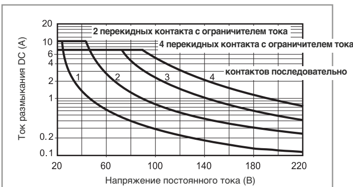
H 59 - Макс. отключающая способность DC1
