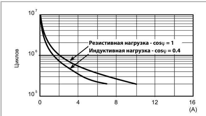
**F 58 - Электрическая долговечность (AC) при ном. нагрузке**
