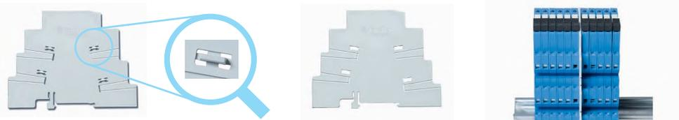
2. Если выступающие ребра не удалять, обеспечивается разделение модулей 6.2 мм. Если с помощью ножниц вырезать пластиковые сегменты разделителя, то для подключения 2 разных групп модулей можно использовать стандартные шинные соединители.
